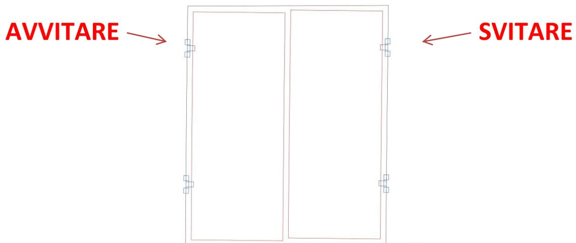
7. Fissare il telaio all'altezza delle cerniere inferiori verificando il corretto allineamento delle ante.
